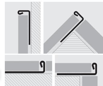
1 Scegliere PROTERMINAL in funzione dello spessore della piastra e della finitura desiderata. 2 Tagliare PROTERMINAL alla lunghezza desiderata ed applicare l'adesivo sul supporto dove sarà posato il profilo. 3 Premere l'aletta di ancoraggio di PROTERMINAL nell'adesivo. 4 Posare le piastrelle avendo cura di allinearle al profilo e di lasciare una fuga di circa 2 mm. 5 Stuccare accuratamente le fughe tra profilo e piastrella onde evitare il ristagno di eventuale acqua.
